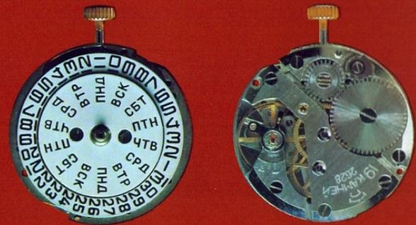
Das Uhrwerk 2628 — Kaliber 26 mm, Werkhöhe 4,75 mm, 19 Rubinsteine, Zentrumsekunde, Stoßsicherung der Unruhewelle, Datum und Wochentagkalendervorrichtung. Schraubenlose Unruh, Schwingungsdauer der Unruh 0,4 s. Flache Spirale, bewegliches Spiralklötzchen. Datumkorrektur, Wochentagkorrektur durch Zeigerdrehung. Gangdauer bei einem Gesamtaufzug der Feder mindestens 40 Std. Genauigkeit in 24 Std. +10...—50 s
