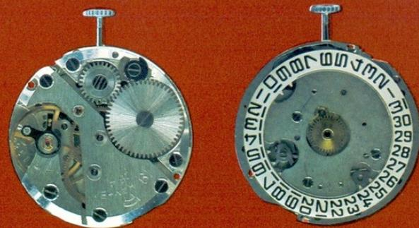
Das Uhrwerk 2614 — Kaliber 26 mm, Werkhöhe 4,45 mm, 19 Rubinsteine, zentraler Sekundenzeiger, Stoßsicherung der Unruhwelle, Datumanzeige. Schraubenlose Unruh, Schwingungsdauer der Unruh 0,4 s. Flache Spirale, bewegliches Spiralklötzchen. Gangdauer bei einem Gesamtaufzug mindestens 40 Std. Genauigkeit in 24 Std.  $10 \dots -50$  s
