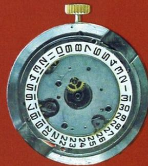
Das Uhrwerk 2616 — Kaliber 26 mm, Werkhöhe 6,25 mm, 29 Rubinsteine, zentraler Sekundenzeiger, Stoßsicherung der Unruhwellen, automatischer Aufzug und Datumanzeige. Gangdauer bei vollem Aufzug der Feder mindestens 43 Std. Beim 10stündigen Tragen der Uhr gewährleistet der automatische Aufzug eine Gangdauer ohne Aufziehen von 30 Std. Genauigkeit in 24 Std. +10...—40 s
