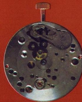
Das Uhrwerk 2609.1 — Kaliber 26 mm, Werkhöhe 4,5 mm, 17 Rubinsteine, zentraler Sekundenzeiger, Stoßsicherung der Unruhwellen. Schwingungsdauer der Unruh 0,4 s. Gangdauer bei einem Gesamtaufzug der Feder mindestens 36 Std. Genauigkeit in 24 Std. —10...—50 s
