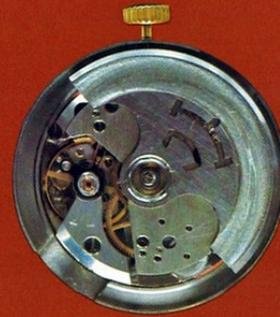
Das Uhrwerk 2627 — Kaliber 26 mm, Werkhöhe 6,55 mm, 29 Rubinsteine, zentraler Sekundenzeiger, Stoßsicherung der Unruhwellen, automatischer Aufzug und Doppelkalender, der Datum und Wochentag anzeigt. Schraubenlose Unruh mit Schwingungsdauer 0,4 s. Gangdauer bei vollem Aufzug der Feder gewährleistet mindestens 43 Std. Beim 10stündigen Tragen der Uhr gewährleistet der automatische Aufzug eine Gangdauer ohne Aufziehen von 30 Std. Genauigkeit in 24 Std.  $\pm 10 \dots -40$  s
