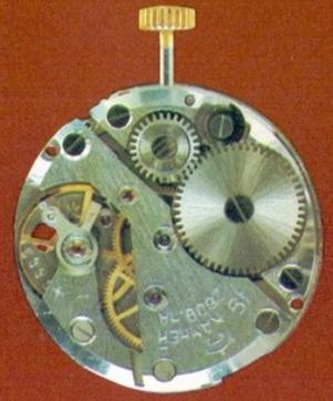
Das Uhrwerk 2609H.A — Kaliber 26 mm, Werkhöhe 3,9 mm, 19 Rubinsteine, zentraler Sekundenzeiger, Stoßsicherung der Unruhswelle. Schraubenlose Unruh, Schwingungsdauer 0,4 s. Flache Spirale, bewegliches Spiralklötzchen. Gangdauer bei einem Gesamtaufzug der Feder mindestens 42 Std. Genauigkeit in 24 Std. +10...—50 s
