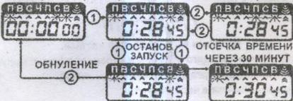
нажатием ② (на индикаторе отображается время на момент фиксации), секундомер продолжает счет. При повторном нажатии ② на индикаторе время с момента запуска.
