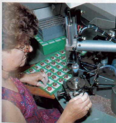
Mit Hilfe dieser Druckmaschine werden Quarzwerke mit dem Aufdruck „Maurice Lacroix“ versehen.
