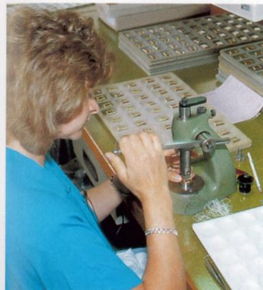
Letzter Produktionsschritt in der Gehäusefabrik: Die Gläser werden eingepreßt.
