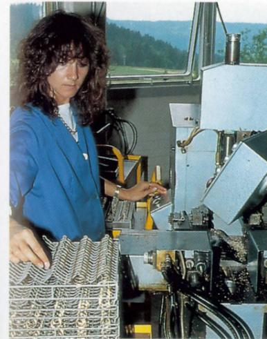
Hier geht es um Stückzahlen, aber auch Genauigkeit: Bei der Gehäuse-Finbearbeitung werden zum Beispiel Kanten geglättet – einer von rund 80 Arbeitsschritten.
