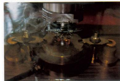
Mit einer Funken-Erosionsanlage werden auf elektro-chemischem Weg Werkzeuge hergestellt. Aus gehärtetem Stahl wird Schicht für Schicht abgetragen und die Form des Werkzeuges herausgearbeitet.
