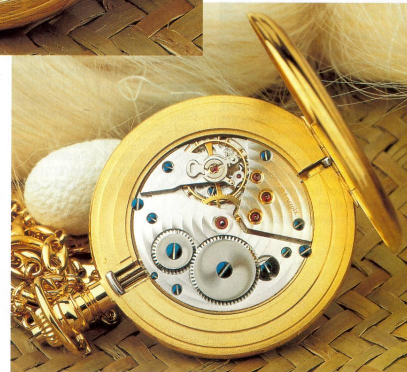
▷ Taschenuhr-Handaufzugwerk Unitas/ETA Kaliber 6497, Durchmesser 36,20 mm, Werkdekoration mit Wölkchenschliff, Schraubenuhr.
