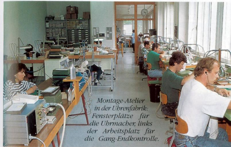
Montage-Atelier in der Uhrenfabrik: Fensterplätze für die Uhrmacher, links der Arbeitsplatz für die Gang-Endkontrolle.
