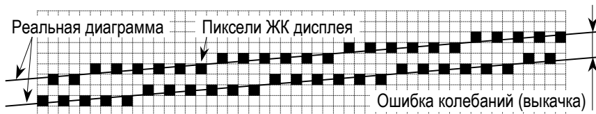
Принцип построения диаграммы на графическом дисплее
