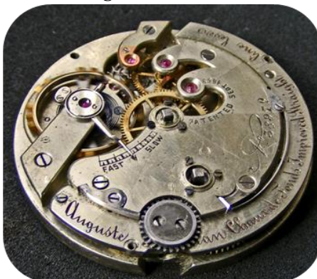
18“-Werk mit der No. 38972 - „Auguste Saltzman“ - nachträglicher Kronenaufzug
