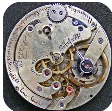
18“-Werk mit der No. 38972 - „Auguste Saltzman“ - nachträglicher Kronenaufzug
