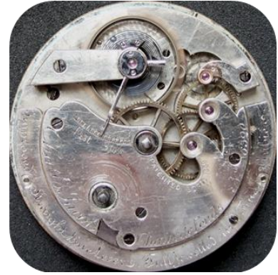
18“-Werk - No. 6320 „Chas E. Jacot“ mit „straight line lever“
