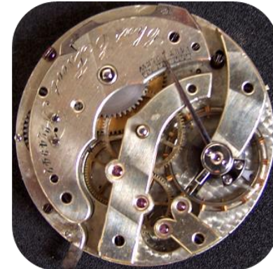
18“-Werk - No. 6320 „Chas E. Jacot“ mit „straight line lever“
