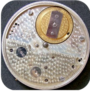
18“-Werk - No. 6320 „Chas E. Jacot“ mit „straight line lever“
