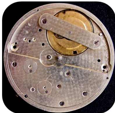
18“-Werk mit der No. 38972 - „Auguste Saltzman“ - nachträglicher Kronenaufzug
