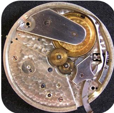
18“-Werk - No. 6320 „Chas E. Jacot“ mit „straight line lever“
