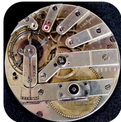
18“-Werk mit der No. 38972 - „Auguste Saltzman“ - nachträglicher Kronenaufzug
