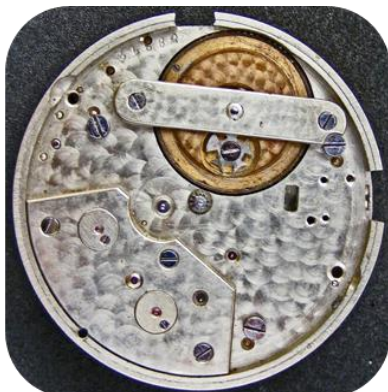
18“-Werk mit der No. 38972 - „Auguste Saltzman“ - nachträglicher Kronenaufzug
