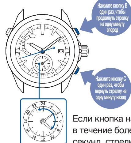
Если кнопка нажата в течение более двух секунд, стрелка начнет непрерывное движение и остановится после следующего нажатия кнопки.
