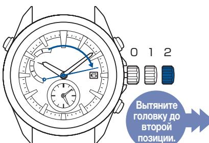
Нажмите кнопку А и держите в нажатом состоянии (три секунды), а затем отпустить ее после того, как секундная стрелка окажется в 0-секундной позиции.
