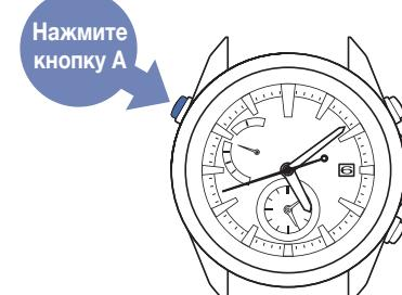
\* Если состояние остановки стрелки продлится минуту и более, то часы автоматически вернутся в режим отображения времени.
