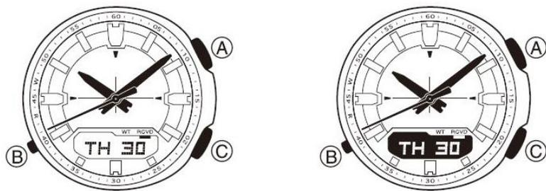
На рисунке изображен общий вид часов в Режиме Текущего Времени. Последовательное нажатие кнопки “В” обеспечивает переход из разряда в разряд в следующей последовательности: Режим Текущего Времени – Режим Приема Сигнала – Режим Мирового Времени – Режим Звукового Сигнала– Режим Секундомера – Режим Таймера Обратного Отсчета –Режим Текущего Времени.
