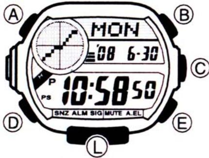
На рисунке изображен общий вид часов в Режиме Текущего Времени. Последовательное нажатие кнопки “D” обеспечивает переход из разряда в разряд в следующей последовательности: Режим Текущего Времени – Режим Барометра/Термометра – Режим Мирового Времени – Режим Секундомера – Режим Таймера Обратного Отсчета – Режим Звукового Сигнала – Режим Записной
