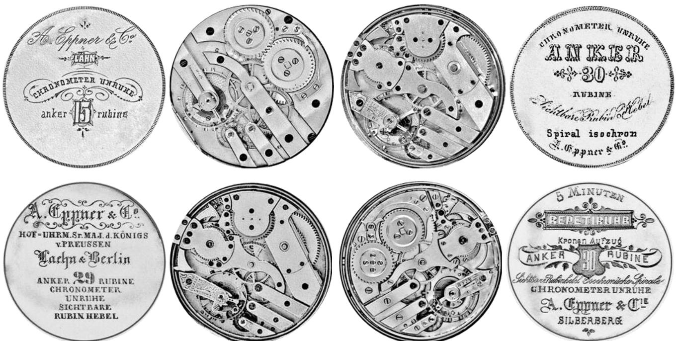
Die Abbildungen zeigen links ein *LeCoultre-Brückenwerk* mit der Deckel-Signatur *LÄHN*, daneben eine *1/4-Stunden-Repetition* Ende der 1860er Jahre mit der Signatur *BERLIN* und eine *1/4-Stunden-Repetitionen* Ende der 1860er Jahre mit der Signatur *Laehn & Berlin*, so wie eine *5-Minuten-Repetition* verm. vom Ende der 1870er Jahre mit der Signatur *SILBERBERG*.
