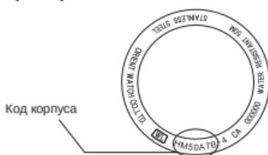
**Пример А:** Если код корпуса «UB8A-Q0», то номер калибра — «UB».
