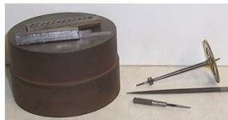
4. Выколотка с держателем и стальным стержнем с различными отверстиями. Обратите внимание, что из-за угла камеры смещение выглядит больше, чем должно.
