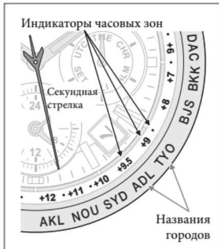
На иллюстрации слева секундная стрелка находится в положении 28 секунд, часовая зона установлена как «+11.5».
