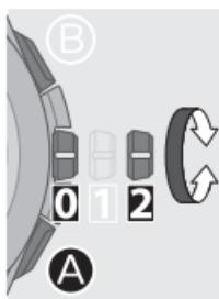
**6 Поворачивая коронку, установите положение стрелки или значение индикатора.**
