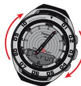
Поверните часы больше чем на один полный оборот на горизонтальной поверхности (например столе), чтобы вокруг не было магнитных помех, со скоростью вращения прилб. 30° в секунду.
