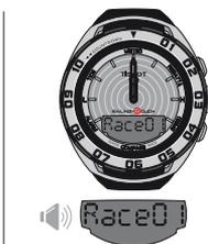
Обратный отсчет времени прекращается и автоматически переходит в режим хронографа гонки. Индикация часов и минут с помощью секундной стрелки на ЖК-дисплее
