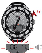
Режим настройки и индикация магнитного отклонения
