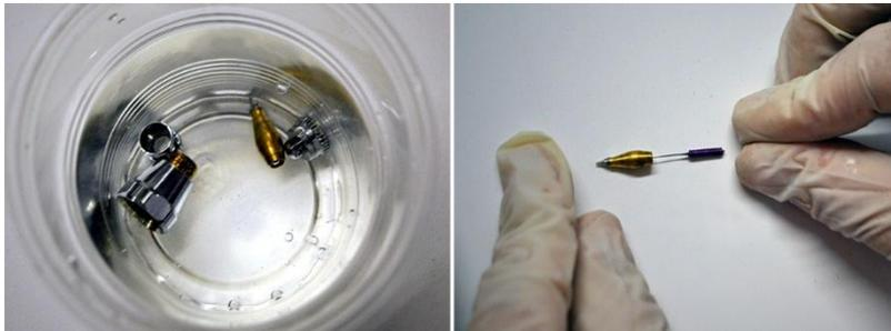
3. После замачивания, вынимаем сопло из растворителя. Для прочистки сопла аэрографа лучше использовать специальную иглу - она значительно тоньше и мягче швейной. Но даже с такой иглой к чистке сопла аэрографа
