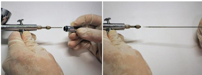
1. Откручиваем заднюю часть корпуса аэрографа. Ослабляем фиксатор иглы, аккуратно вынимаем иглу.
