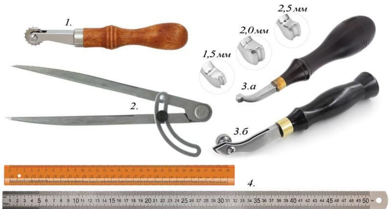
Рис.4. Разметочный инструмент (1 – колесная басма, 2 – кронциркуль, 3.а – кризер нерегулируемый, 3.б – кризер регулируемый, 4 – линейки)
