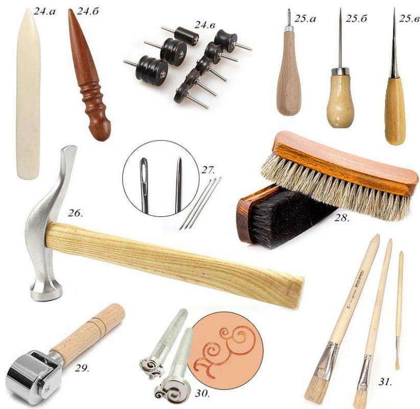
Рис.9. Остальной инструмент (24.а – костяной сликер, 24.б – деревянный сликер, 24.в – сликеры для дрели, 25.а – крестовое шило, 25.б – круглое шило, 25.в – конусное шило, 26 – сапожный молоток, 27 – иглы, 28 – щетки, 29 – стальной валик, 30 – штампы с примером оттиска, 31 – кисти)
