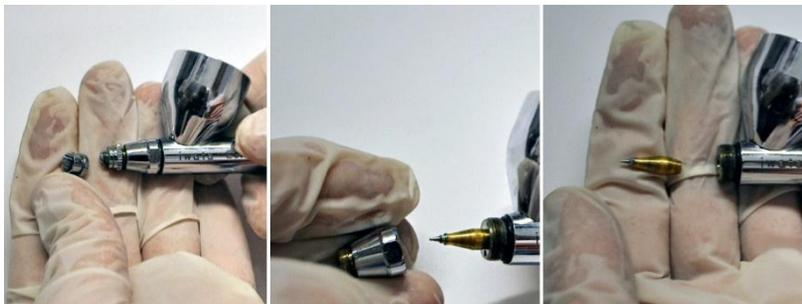
2. Откручиваем колпачок (защиту иглы) и фиксатор сопла, вынимаем сопло из гнезда и замачиваем их в чистом растворителе.
