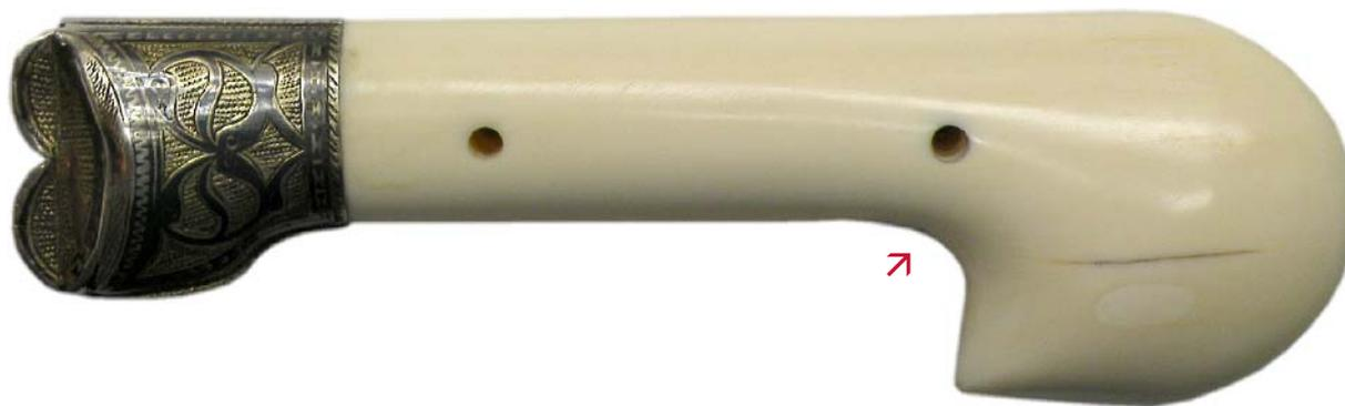
*Пример заполнения выбоины на поверхности рукоятки шашки (моржовый клык). На фото хорошо видна разница между плотным наружным слоем кости и малопрочной крупинчатой внутренней зоной. Как раз оттуда и выпал небольшой фрагмент, и образовавшуюся пустоту пришлось пломбировать. После удаления излишков и шлифовки место аварии стало совершенно незаметным.*
