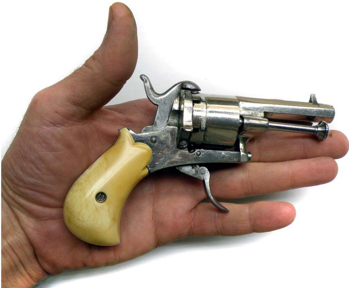
Моржовый клык не столь однороден, как слоновая кость. Он имеет отчетливую структуру, состоящую из прочной, плотной внешней оболочки толщиной до 10мм (а), и хрупкой сердцевины, похожей на спрессованный сахар (б), обычно пронизанной сеткой поперечных трещин. При изготовлении крупных деталей типа рукоятки шашки без сердцевины обойтись не получается, и в этом морж проигрывает слону.
