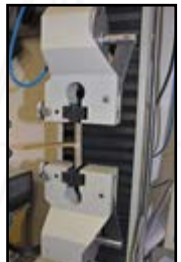
Peeling Lamination strength (EN 12774)
