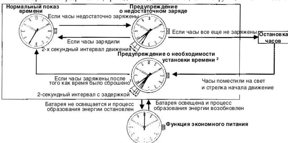
1: Если часы не переустановлены, будет продолжаться движение с 2-секундным интервалом и задержкой.
