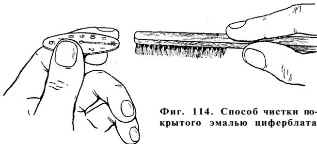
Фиг. 114. Способ чистки покрытого эмалью циферблата.
