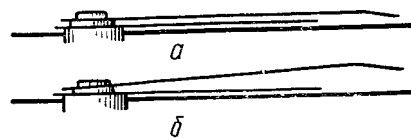
Рис. 109. Установка стрелок: а — правильная; б — неправильная
